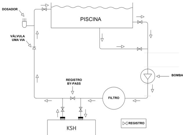
INSTALAÇÃO BOMBA CALOR PISCINA + SPA COM BOMBA DE ÁGUA DO SISTEMA DO SISTEMA DE FILTRAGEM
