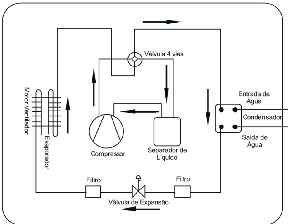
Durante o processo de operação, a bomba de calor KSH absorverá grande parte da energia térmica do ar e a transferirá para a água, juntamente com a energia proveniente do trabalho do compressor.
