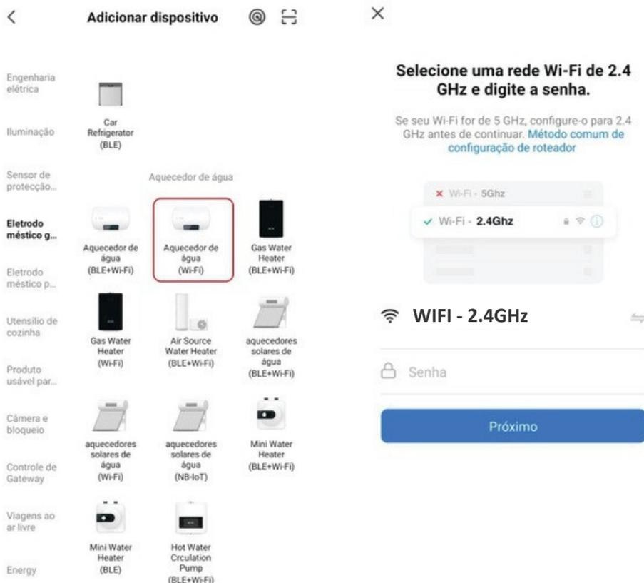
Para conectar a bomba de calor ao controle via aplicação, certifique-se de que o sinal de seu Wi-Fi esteja com boa qualidade. A recomendação é de que o modem, roteador ou repetidor de sinal esteja até 20 metros de distância livre ou até 10 metros com obstáculos, como paredes etc. Caso use roteador ou repetidor de sinal, assegure que o mesmo esteja recebendo sinal de boa qualidade. O sinal de Wi-Fi recebido pelo controlador é apenas para rede de 2.4 GHz.
